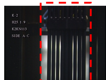
C面からの透過光による 燃料棒-ウオータ・ロッド間隔の A面からの確認
