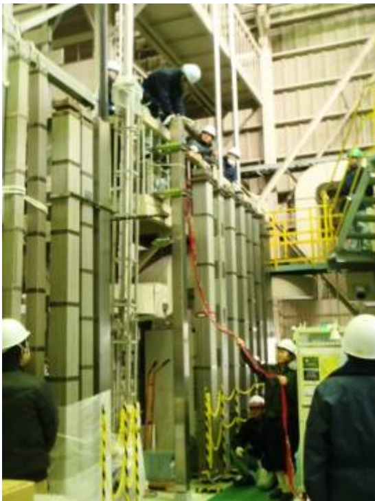
図 2-2 原子燃料工業株式会社熊取事業所の燃料起立台
