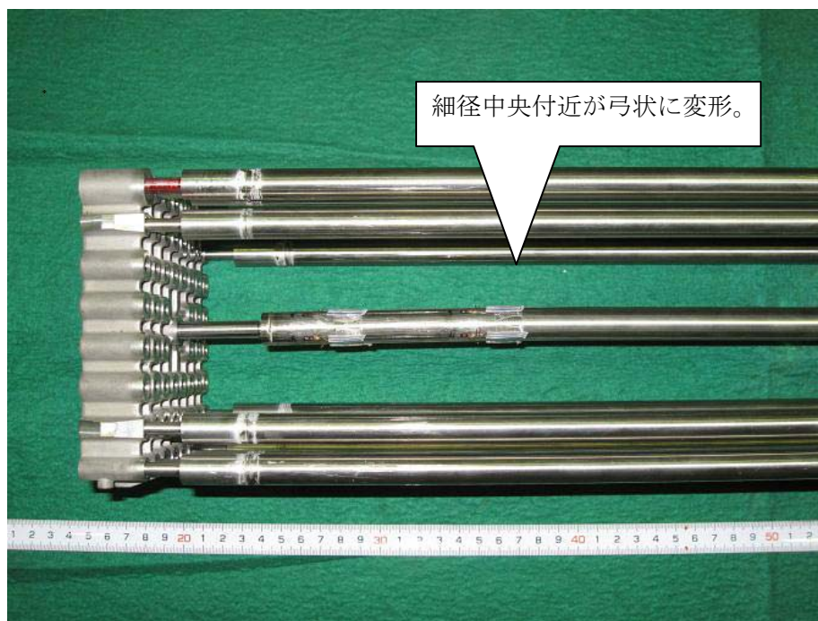
一撃落下試験 落下高さ H=300\text{mm} , 最大反力 F=14\text{kN}
