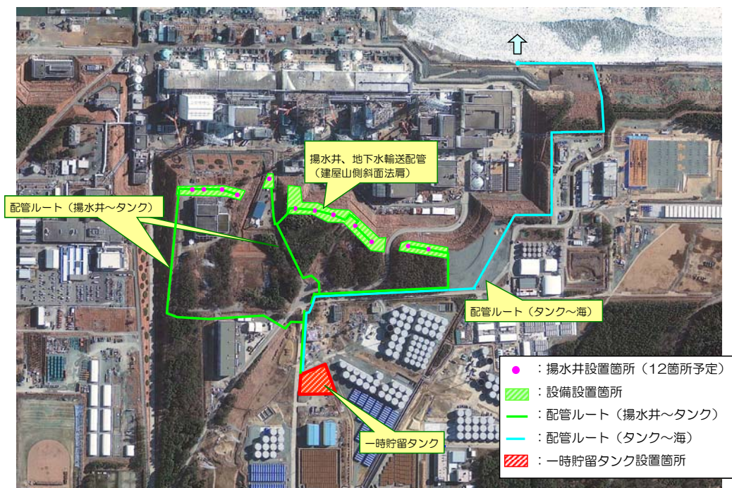
図二 地下水バイパスの設備
