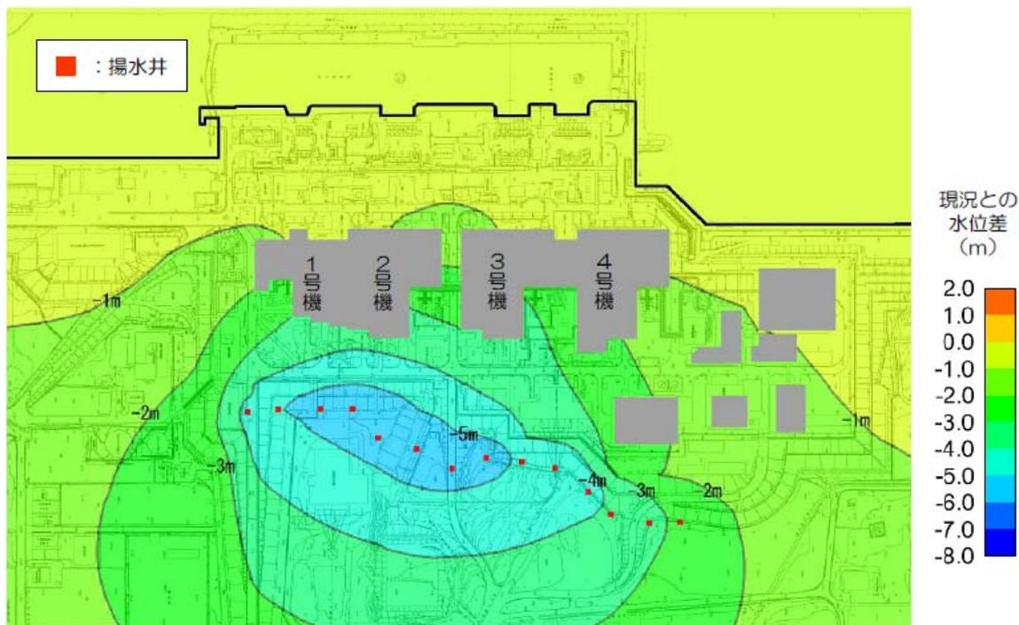
図5-3 地下水バイパス稼働による現況からの地下水位低下量（想定）
