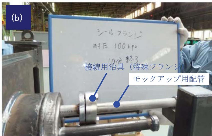
図6-9 配管改造工法試験概要
