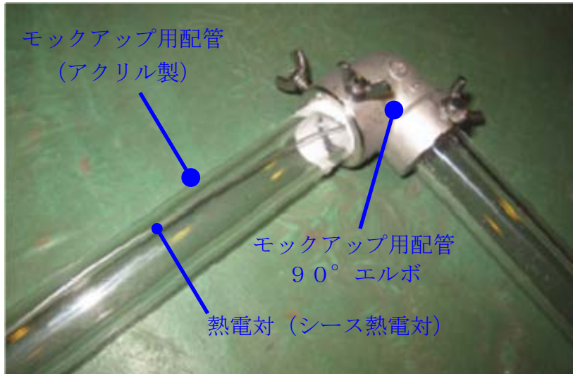
図6-8 配管挿入試験概要 (シース熱電対を通してしている例)
