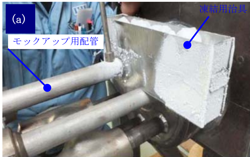
図6-8 配管挿入試験概要 (シース熱電対を通してしている例)
