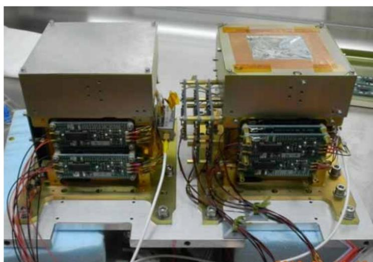
図:2 JAXA が世界にさきがけて開発した Si/CdTe コンプトンカメラの原理実証モデルの写真。このモデルでは Si2層、CdTe3 層を密に多層構造にした。このような構造にすることで超広角の視野と核種固有のガンマ線を認識するエネルギー分解能を併せ持つ次世代型のコンプトンカメラが実現する。ここでは超広角コンプトンカメラを
