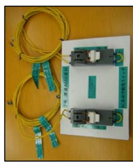
仮設スイッチ付きケーブル (AC系ベント弁用)
