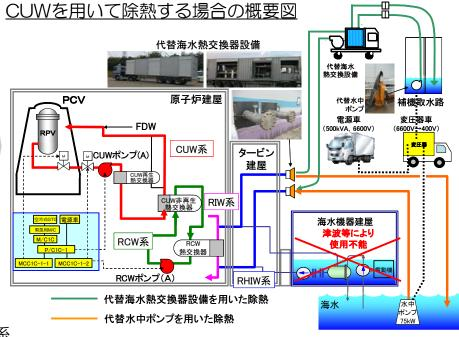
※RHIW: 残留熱除去冷却中間ループ系 RIW: 原子炉補機冷却中間ループ系 RCW: 原子炉補機冷却系
