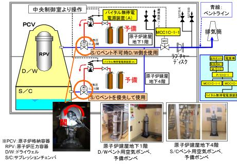
※手動によるベント弁開放操作場所と 原子炉格納容器との間はコンクリート壁で 遮られており、放射線の遮蔽効果が期待できる。
