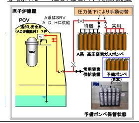
【原子炉の除熱】電源供給、原子炉の除熱及び海水への放熱手段の多様化
