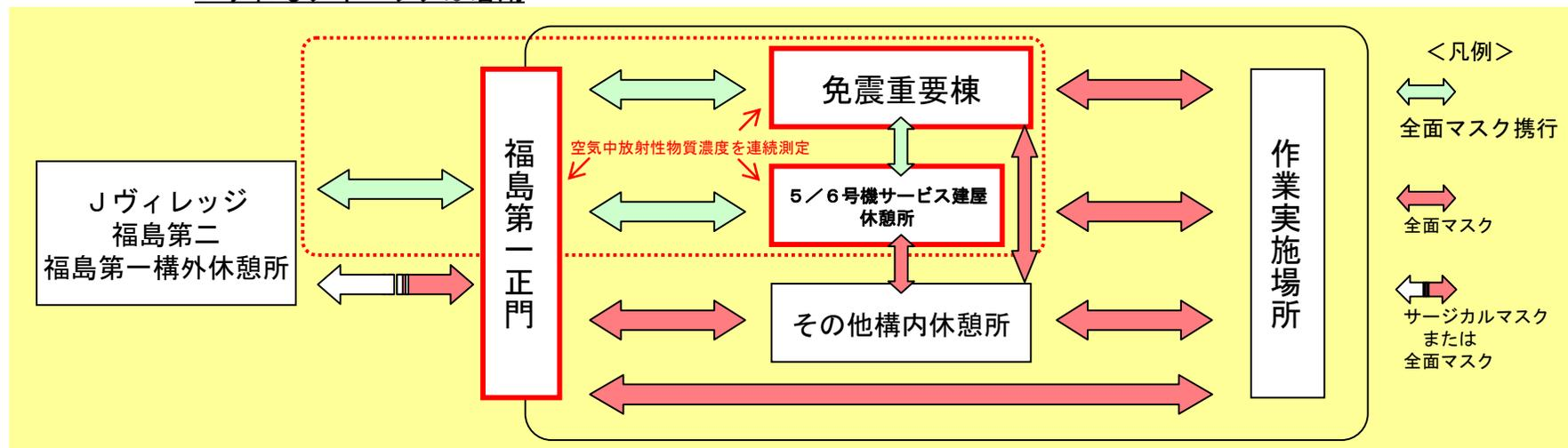
■ **運用変更後** : 福島第一原子力発電所の免震重要棟または5/6号機サービス建屋休憩所に直行する場合の移動車両内および免震重要棟前・5/6号機サービス建屋休憩所前・正門付近における屋外では、全面マスク着用の省略可能に加え、「移動用車両」の場合は一般作業服（移動用タイベックも可）を着用
