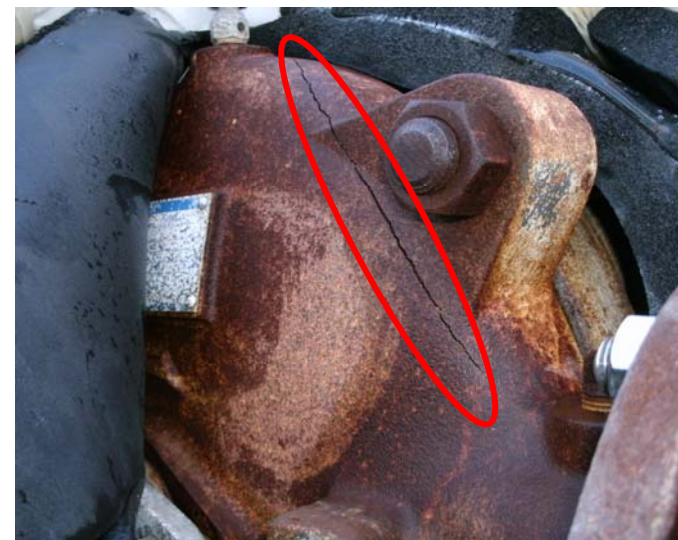
No.7: 純水タンク脇炉注水ポンプ(B) ポンプケーシング
