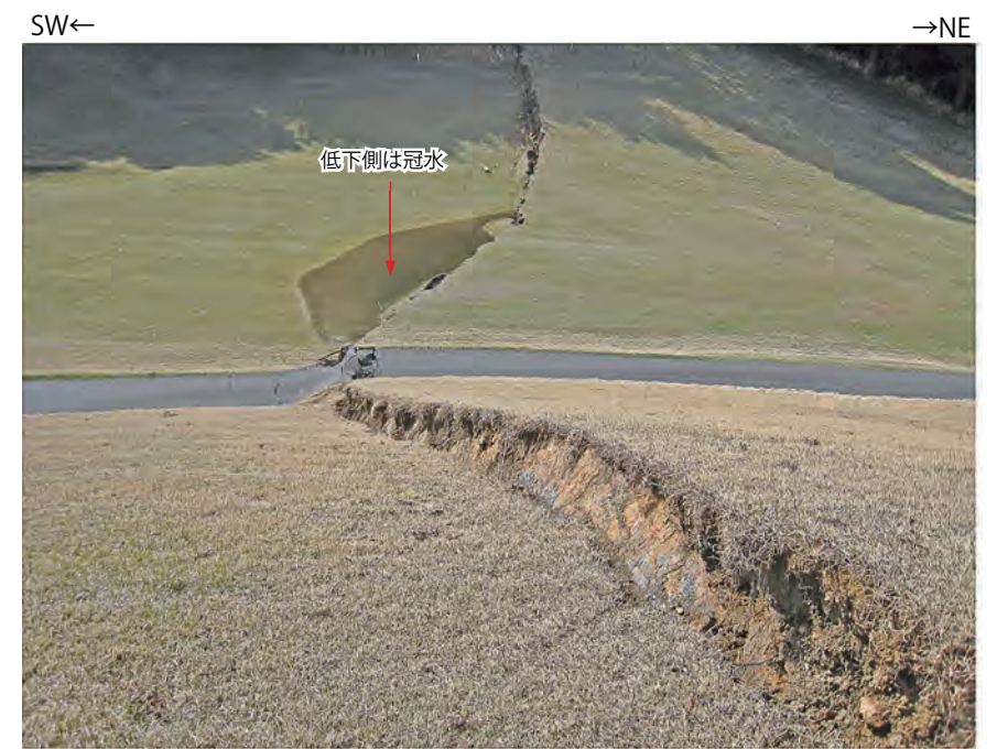
Loc.Y-24 2011.4.24 撮影 ゴルフ場に出現した地震断層。南西落ち 50cm～70cm の上下変位が認められる。
