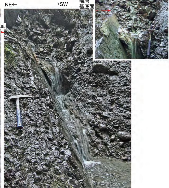
同左拡大. 礫層基底面に約 25cm 南西落ちの垂直変位が認められる。 断層面沿いに数 mm の軟質粘土が認められる。
