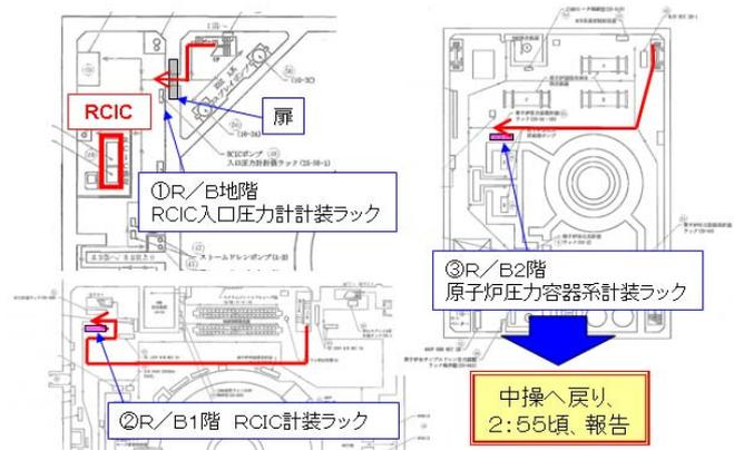
5. 6MPaであることを確認。RCIC 吐出圧力が原子炉圧力を上回っていることから、RCIC が運転（機能）していると考えた。中央制御室へ戻り、2:55、発電所対策本部へ報告。
