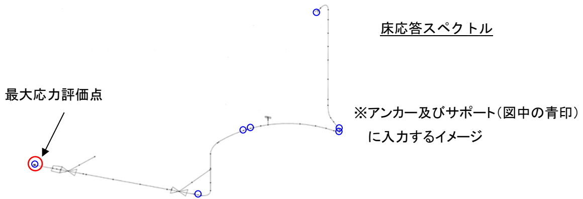
主蒸気系配管モデル (一部)
