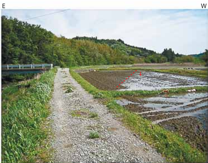
Loc.3x(いわき市遠野町根岸根本川下流右岸) 水田に西側低下の上下変位が認められる。
