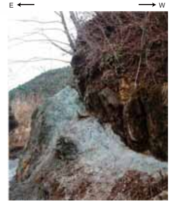
断層露頭スケッチ・写真(Loc. Ht1217): 蛇紋岩内に断層がみられる。断層面は湾曲が著しい。断層面の東側幅約1mは粘土質鱗片状破砕部となっており軟質である。また、さらに東側の蛇紋岩も節理が密集している。
