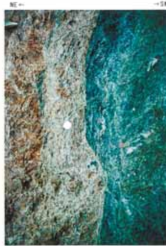
同左拡大 断層部の両側にはそれぞれ幅10~15cmの節理密集部がみられる。断層面沿いには最大幅 5mmの粘土がみられるが、コインの右では断層面沿いに粘土は認められない。
