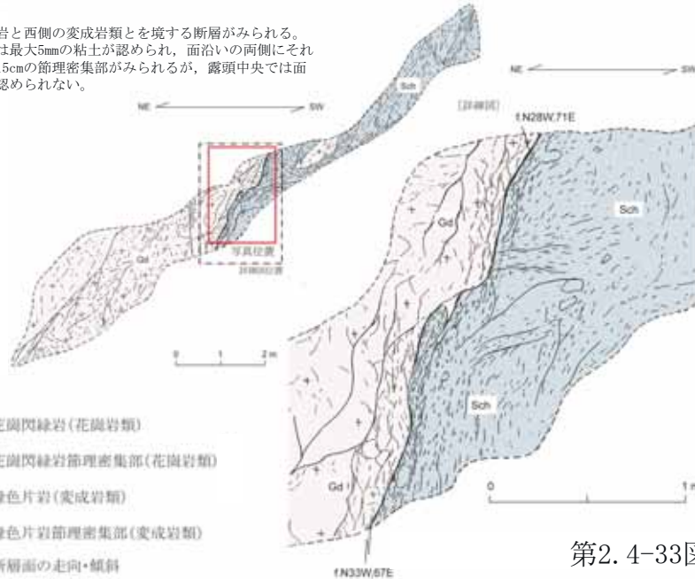
同左拡大 断層部の両側にはそれぞれ幅10~15cmの節理密集部がみられる。断層面沿いには最大幅 5mmの粘土がみられるが、コインの右では断層面沿いに粘土は認められない。
