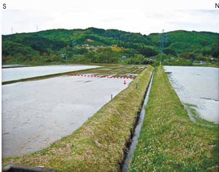
Loc.3t(いわき市遠野町根岸根本川中流左岸) 水田に東側(手前)低下の上下変位が認められる。
