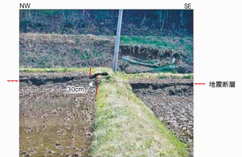
同左 水田の畔に左横ずれ約 30cm の水平変位が認められる。
