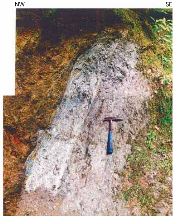
花崗閃緑岩内の断層。2条の断層面がみられ、その間の約30cmが破砕部となっている。
