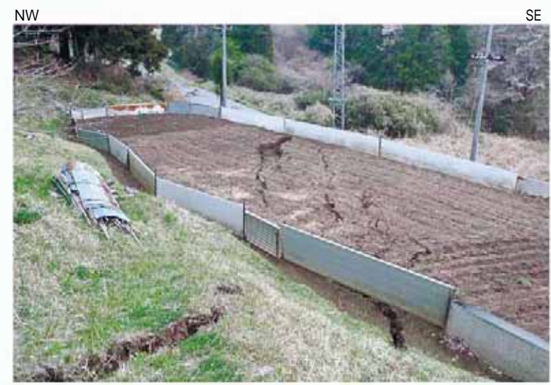
Loc.y-29 開口クラックが数条認められ、南東落ちの上下変位を伴う。
