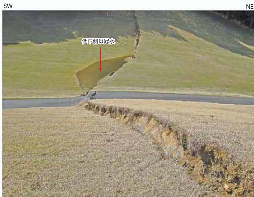
Loc.Y-24 ゴルフ場に出現した地震断層。南西落ち 50cm ~ 70cm の上下変位が認められる。
