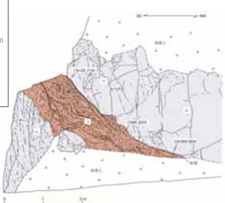
断層露頭スケッチ・写真(Loc. Ht1217): 蛇紋岩内に断層がみられる。断層面は湾曲が著しい。断層面の東側幅約1mは粘土質鱗片状破砕部となっており軟質である。また、さらに東側の蛇紋岩も節理が密集している。
