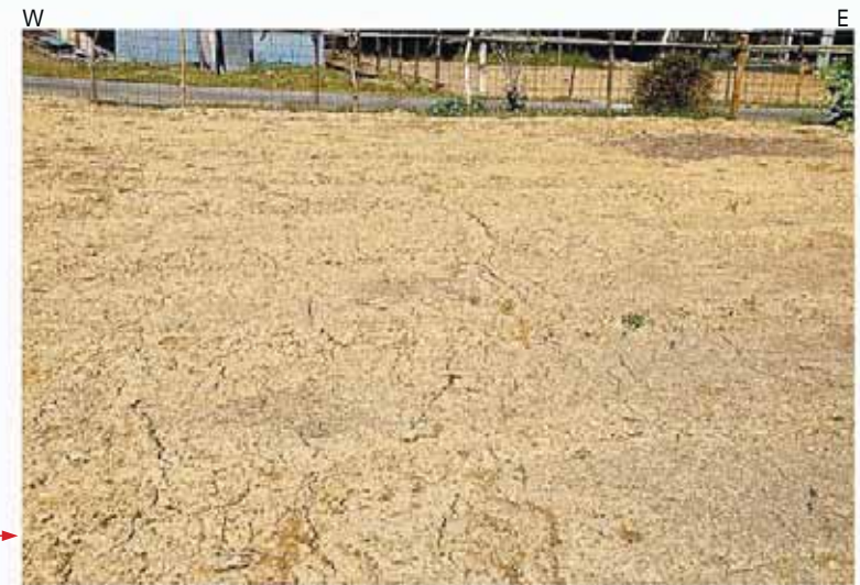
同左 畑面に N-S 方向のクラックが発達する。
