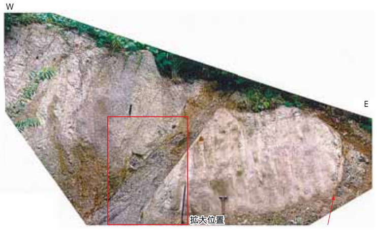
Loc.K611 南西側の平層と北東側の水野谷層とを境する湯ノ岳断層水野谷層と変成岩との境界 (↑) には断層は認められない。
