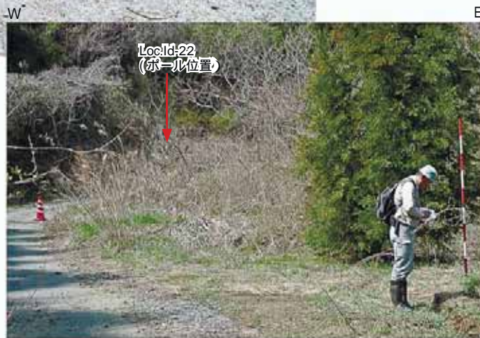
Loc.Id-22 道路面に出現した地震断層。 西落ち約 70cm の上下変位が認められる。
