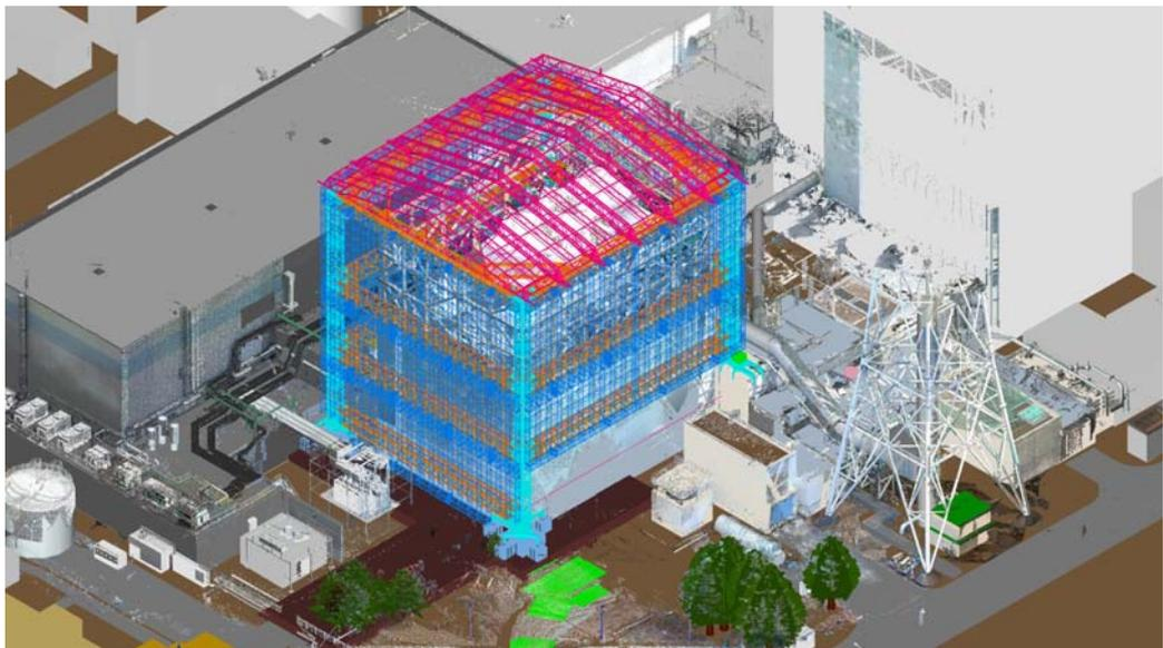
(b) 点群データから変換されたポリゴンデータと3次元建物CADデータの合成
