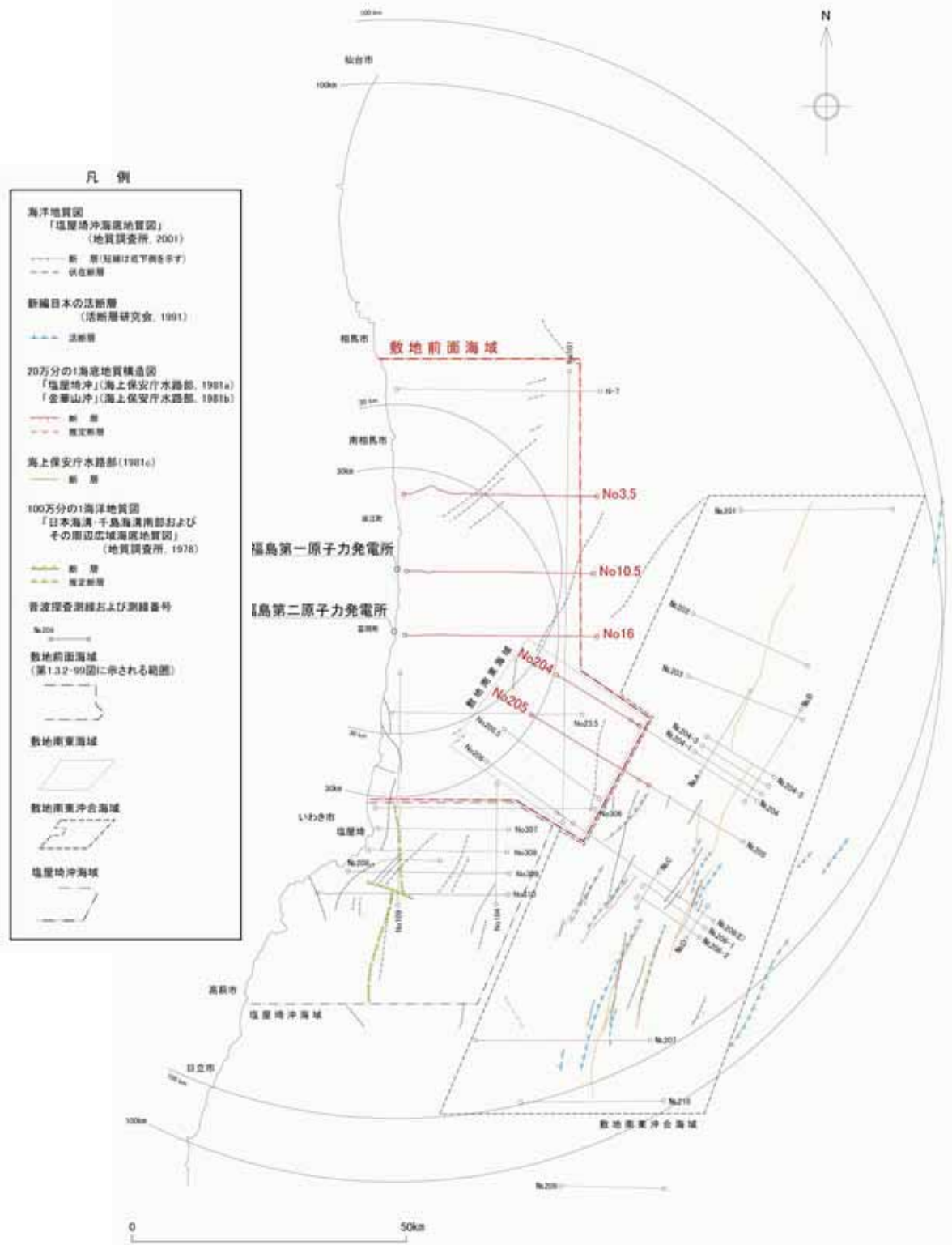
敷地周辺海域の文献による断層分布図及び音波探査測線位置図
