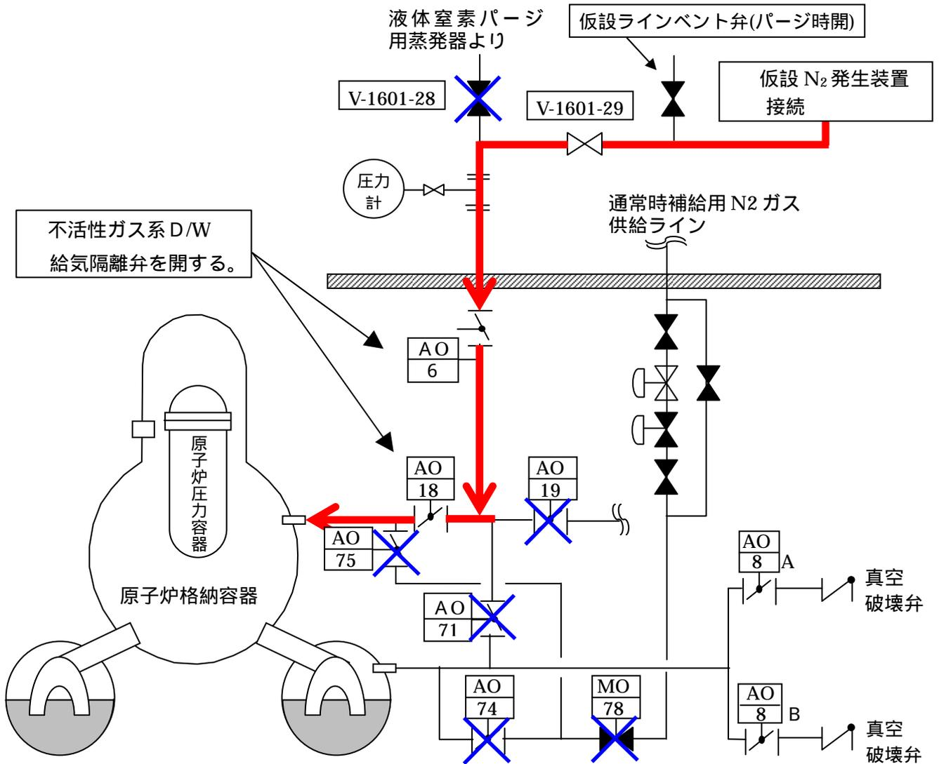
原子炉格納容器への窒素ガス封入 系統概略図
