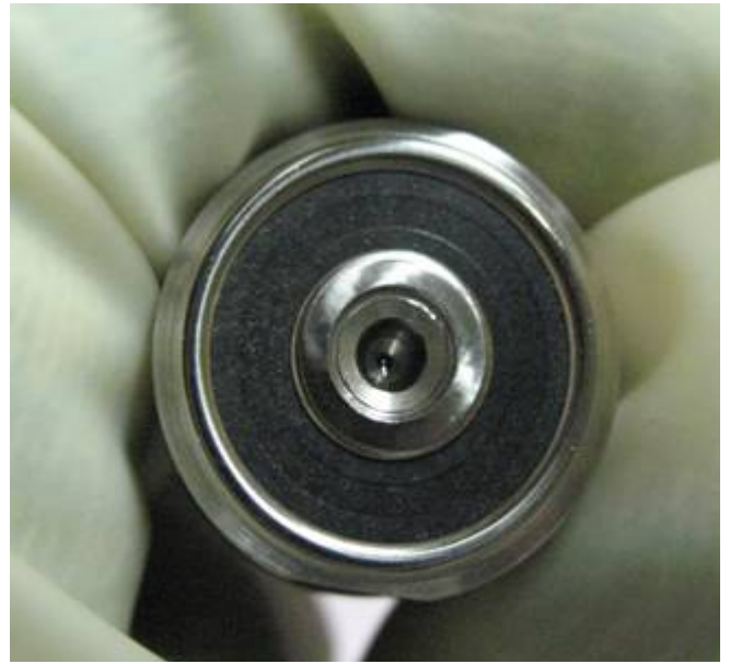
図3. 弁体シート面 (123弁)
