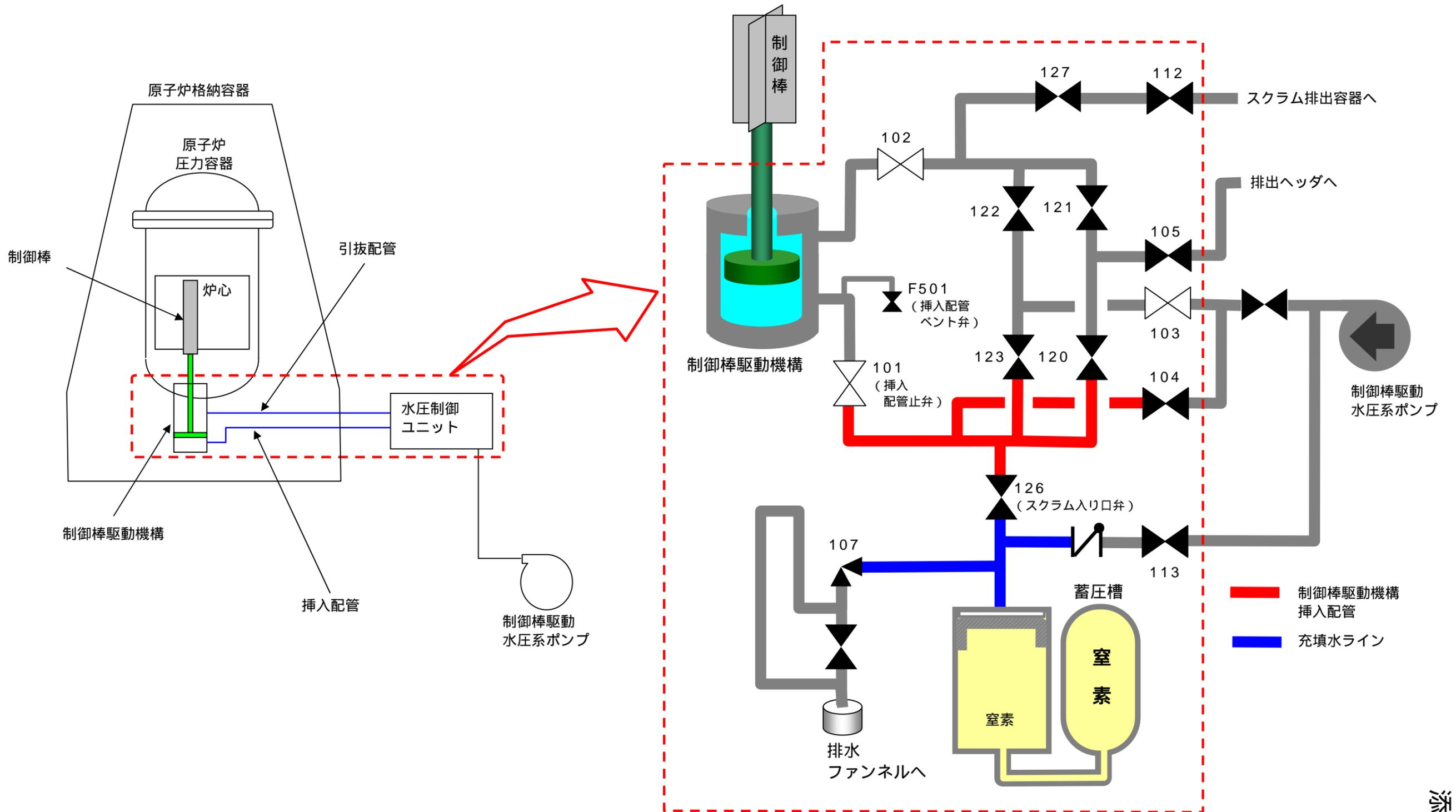
柏崎刈羽原子力発電所 3 号機 制御棒駆動水圧系 概略図
