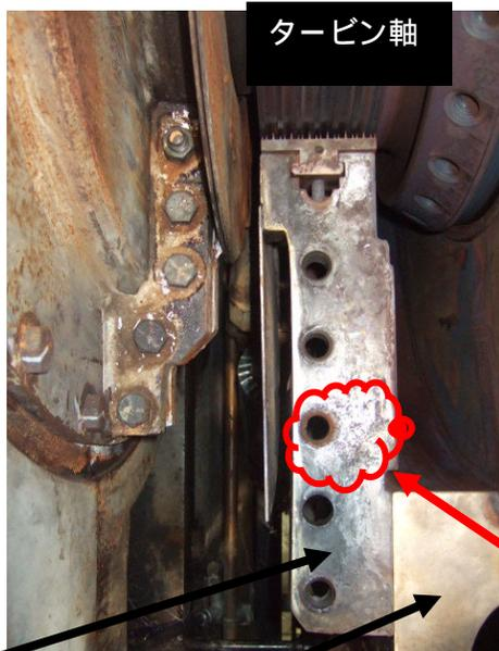
蒸気出口側タービン軸封部ケーシングの合わせ面
