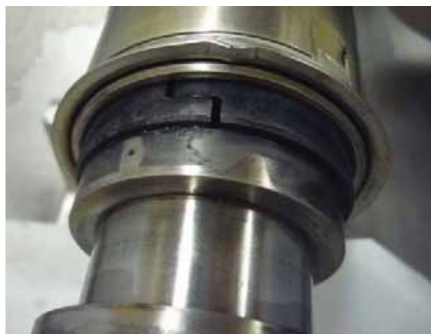
ピストンチューブ上端付近の クラッド付着状況
