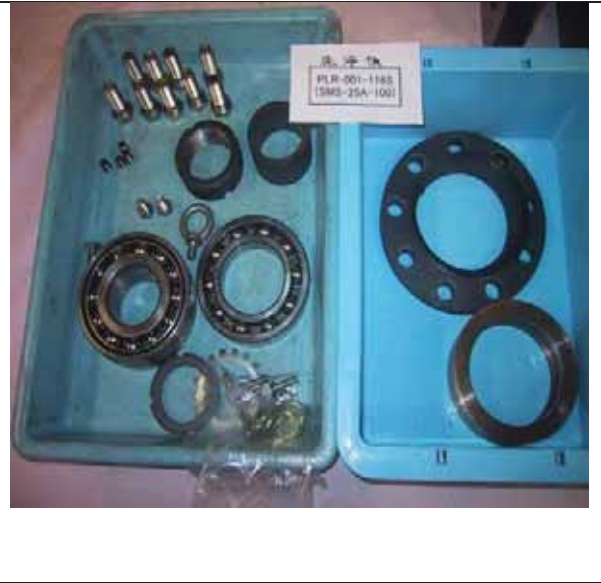
原子炉再循環系配管メカニカルスナッパ
