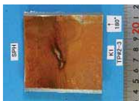
配管内面付着物
