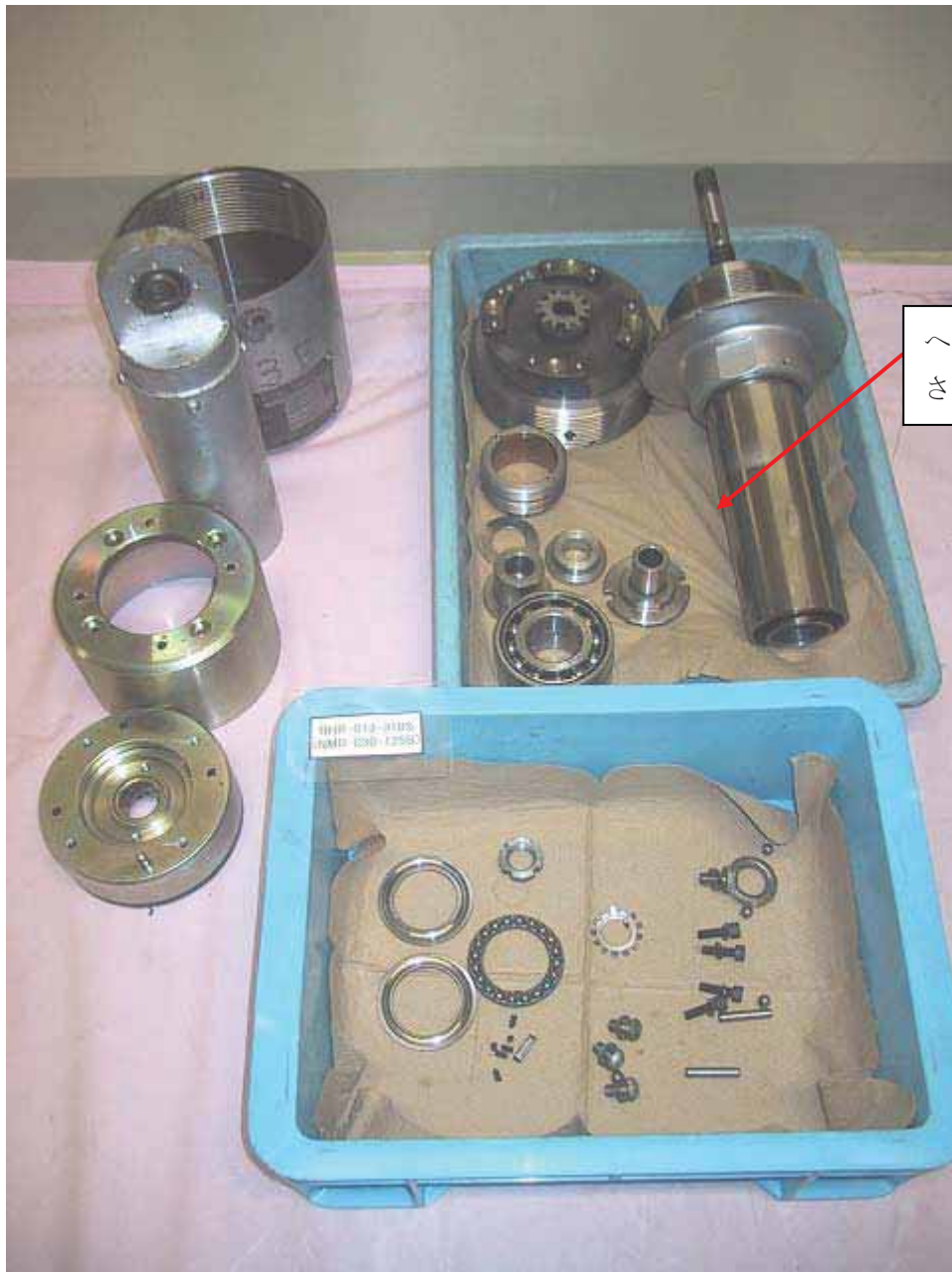
残留熱除去系配管メカニカルスナッパ 分解写真
