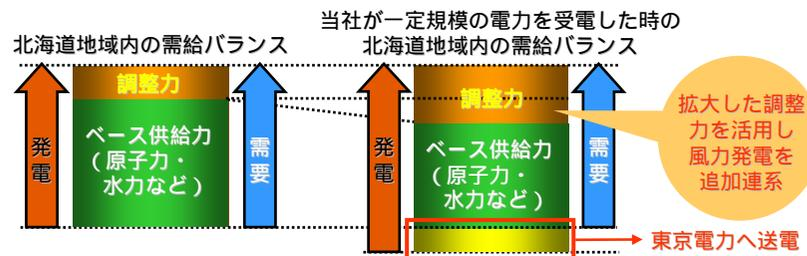
● 風力発電出力制御技術の組み合わせ
