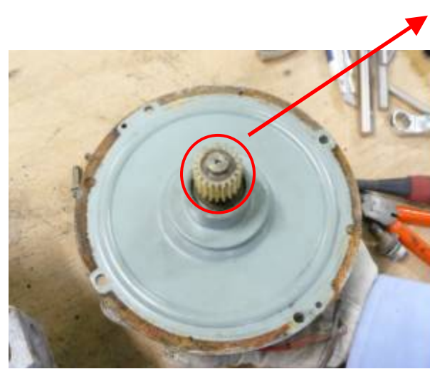
①送給モータ外観 装置本体から取り外し確認した結果、 発熱・着火した痕跡は見られない
