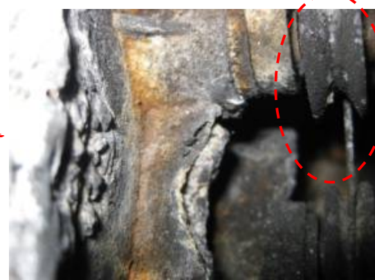
⑫ワイヤ送給減速機カバー ・ワイヤ送給減速機カバー中央部の補強板一部焼失
