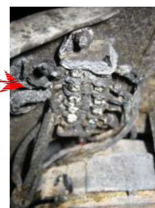
③中継端子台 ・中継端子台カバーの痕跡は確認 できず ・中継端子台には焼痕 ・中継端子台に接続されている線に 焼痕
