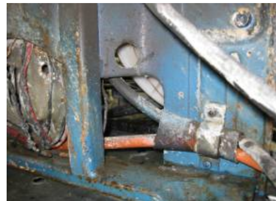
⑩ガスホース及び制御ケーブル固縛部 ・ガスホース(オレンジ色)及び 制御ケーブル(青)共軽い焼け焦げ
