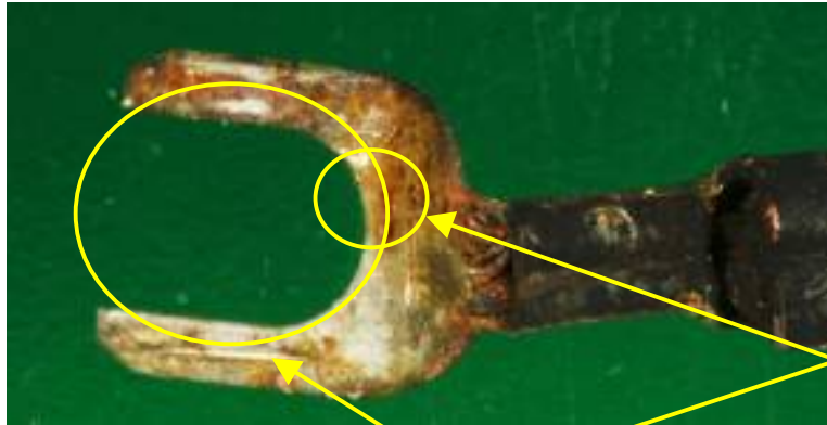
a(a-cジャンパー線)端子(表面)の一部にキズ (アーク痕)
