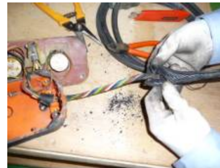
③リモコンボックスケーブル内部 ケーブルの被覆を剥がして確認したが 損傷等異常は見られない
