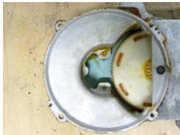
⑦減速機内部部品 減速機内部部品を確認した結果、発熱・着火した痕跡 やグリスが溶け出した様子は見られない
