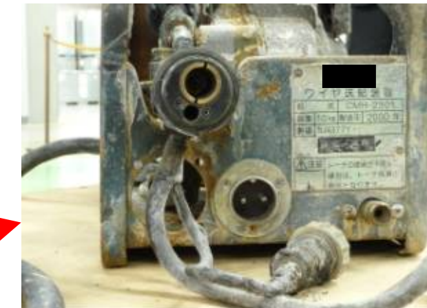
⑥給電部（ワイヤ送給装置側） 給電部（ワイヤ送給装置側）を確認した結果、 発熱による変色やアーク発生痕は見られない
