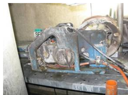
①ワイヤ送給装置全体 (中央図とは反対側から撮影)
