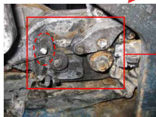
⑪ワイヤ送給減速機カバー ・ワイヤ送給減速機カバー全体に焼痕 ・ワイヤストレートナのストレートロール, スラストワッシャ, E形止め輪無し
