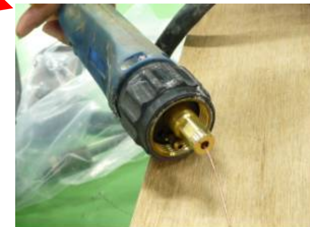
⑨給電部（トーチ側） 給電部（トーチ側）を確認した結果、発熱による 変色やアーク発生痕は見られない
