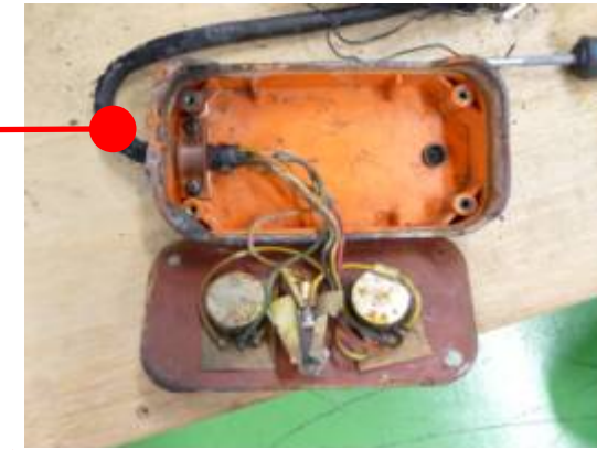
④リモコンボックス内部 リモコンボックス内部を確認した結果、 発熱・着火した痕跡は見られない
