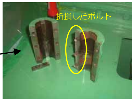
7号機シャフトカップリング部の分解
