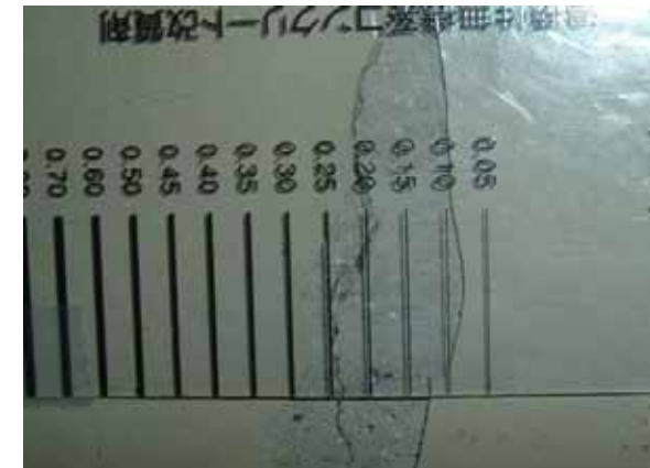
北側側面ひび割れ状況
