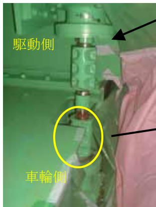
7号機シャフトカップリング部 (カップリングキーにて連結)
