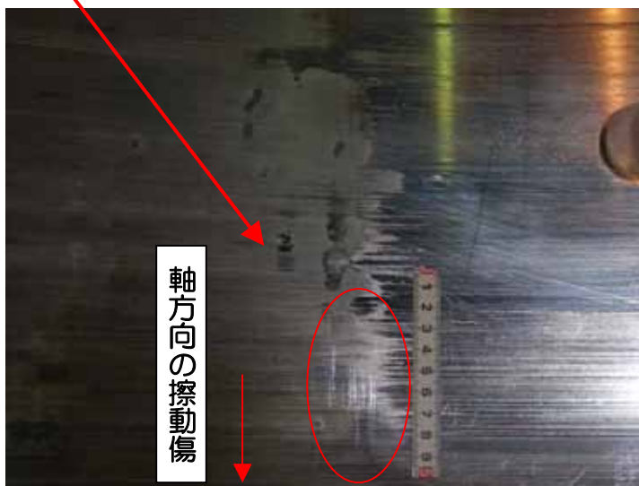
軸受の損傷状況
