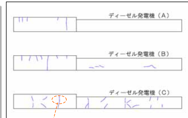
北側側面ひび割れ状況
