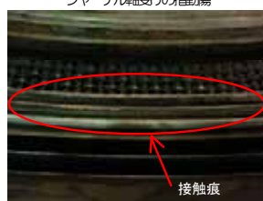
タービン軸 (タービンロータ) の軽微な接触痕
