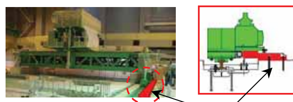
ガイドプレートの設置
