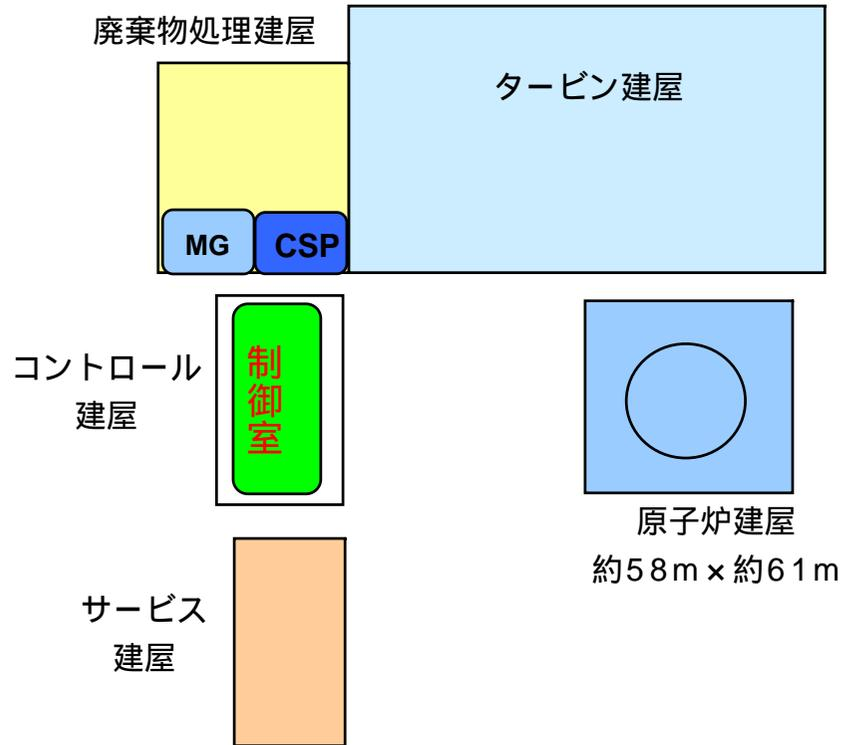
MG : 再循環ポンプ電源装置
