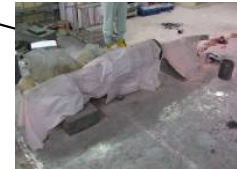
ポンプシャフト 養生シート溶融 床面(ブリキ板)焼け跡有り
