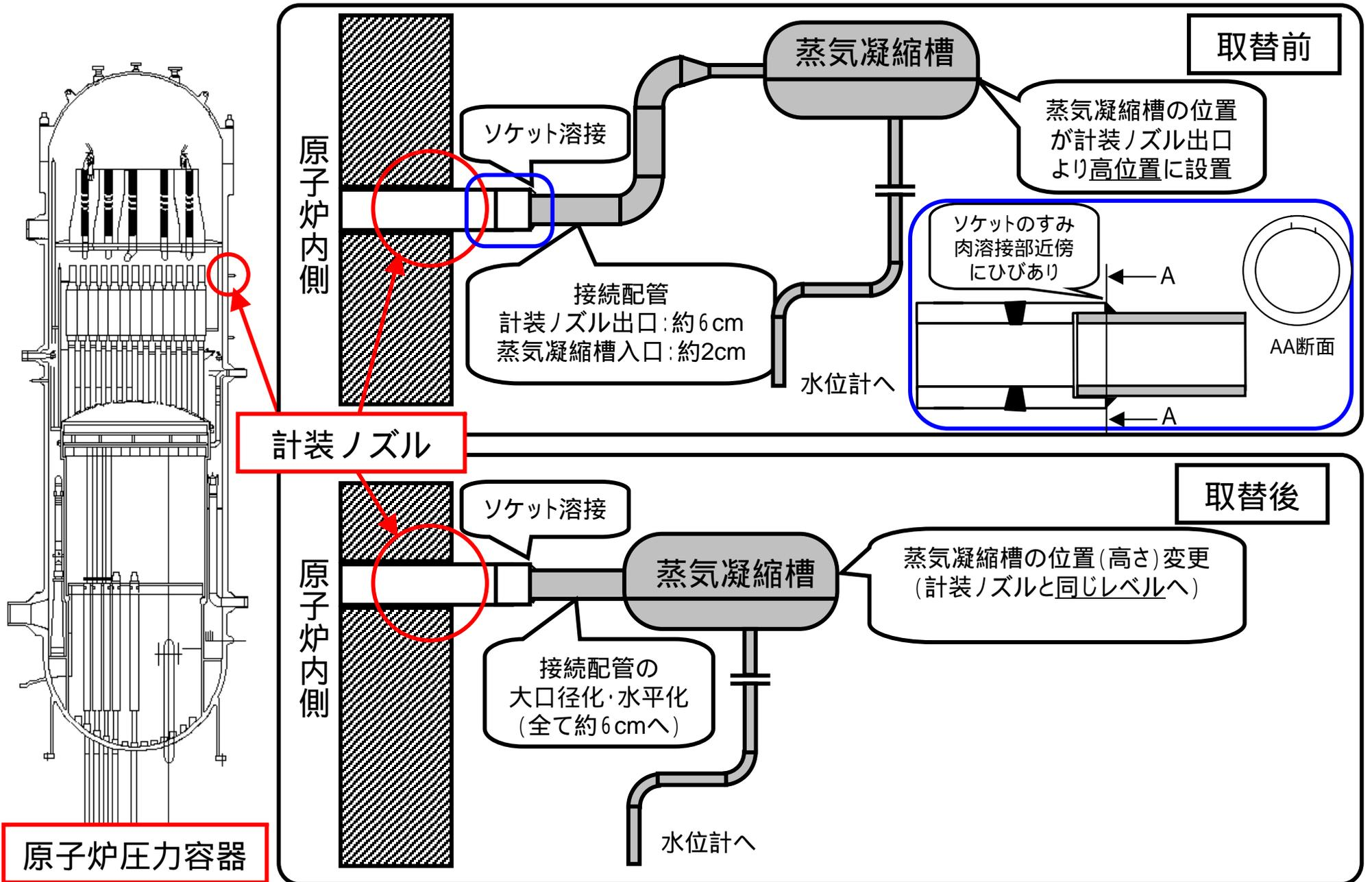
柏崎刈羽原子力発電所1号機 計装ノズルひびび状況(H10年)
