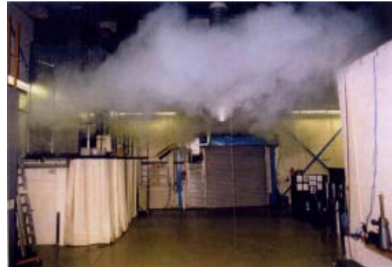
図5．置換換気空調用吹き出し口の冷暖房時の気流パターンの切り替え例
