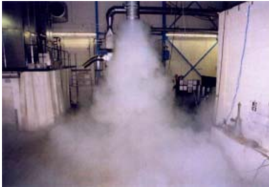
図5．置換換気空調用吹き出し口の冷暖房時の気流パターンの切り替え例
