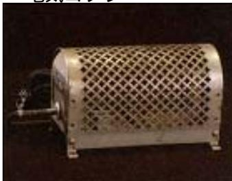
三菱電機製で、昭和初期に使用された。対流形で、発熱体からの放熱がまわりの空気を暖め、やぐら内部の空気を対流させながら温度を上げる。
