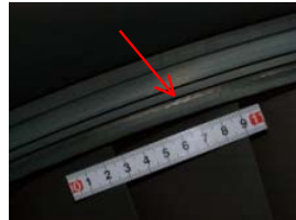
第9段発電機側ダイヤフラム
