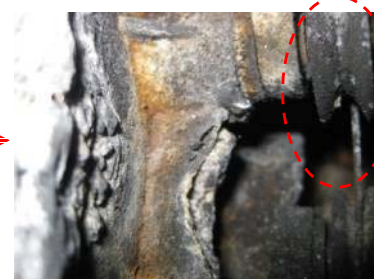
ワイヤ送給減速機カバー ・ワイヤ送給減速機カバー中央部の補強板一部焼失
