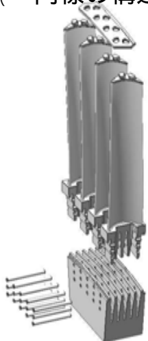
フォークピン型動翼 (第14段の例)
