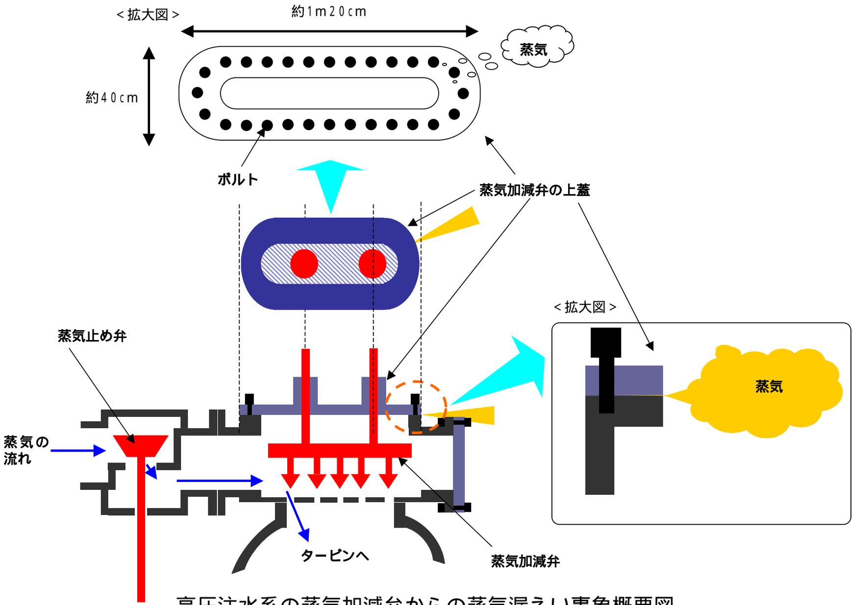
高圧注水系の蒸気加減弁からの蒸気漏えい事象概要図
