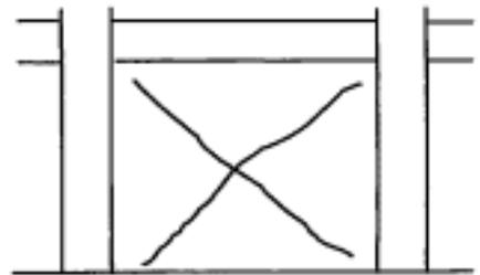
地震時に壁の中央で斜め方向にひび割れが交
