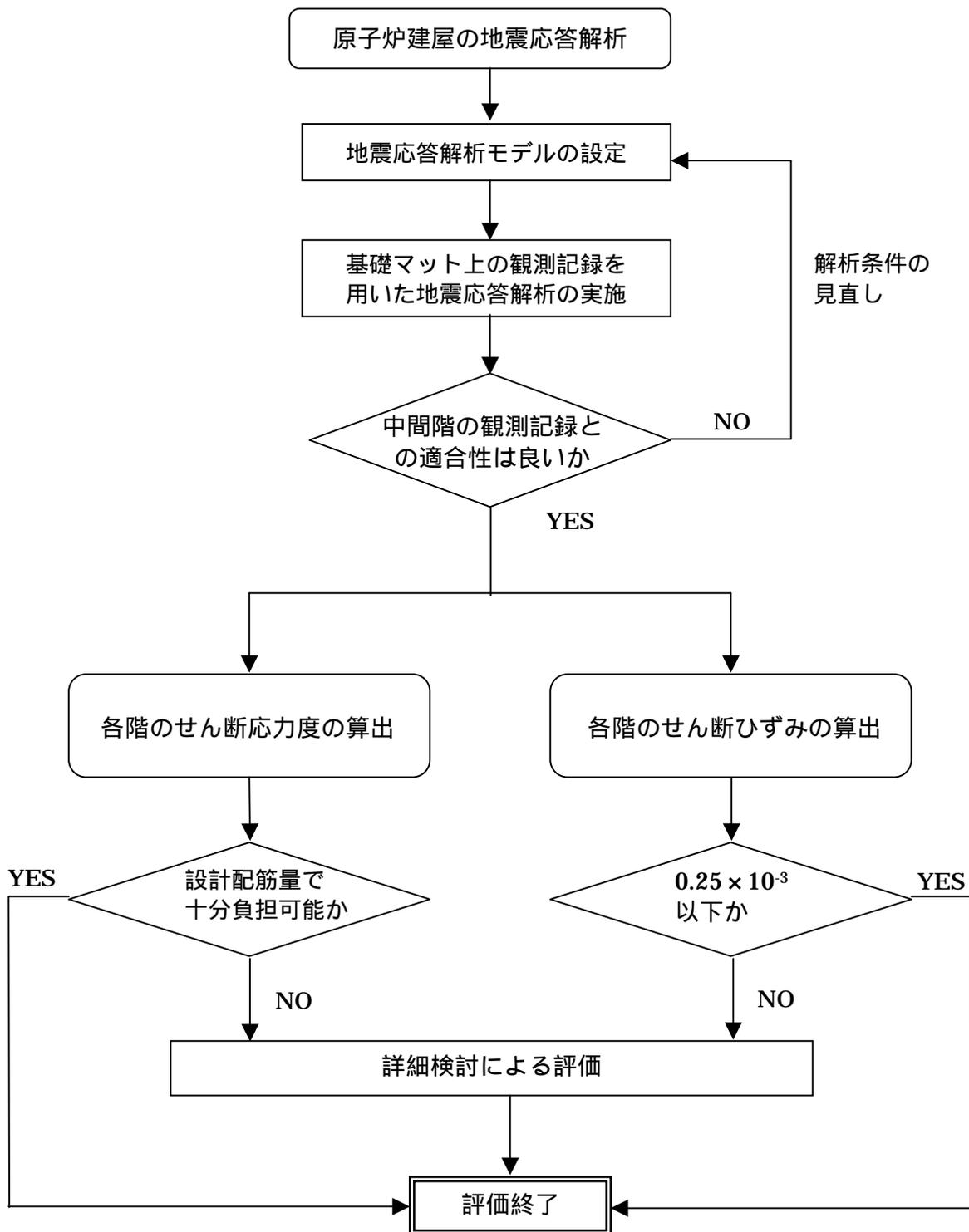
図-4.1 原子炉建屋の地震応答解析の評価手順
