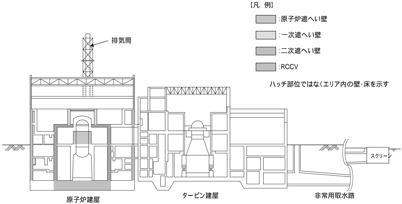
図1 点検・評価対象の建物・構築物の断面図
