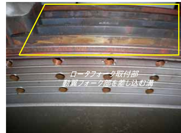
第14段ロータの外観 (非破壊検査の実施部位を側面から見る)
