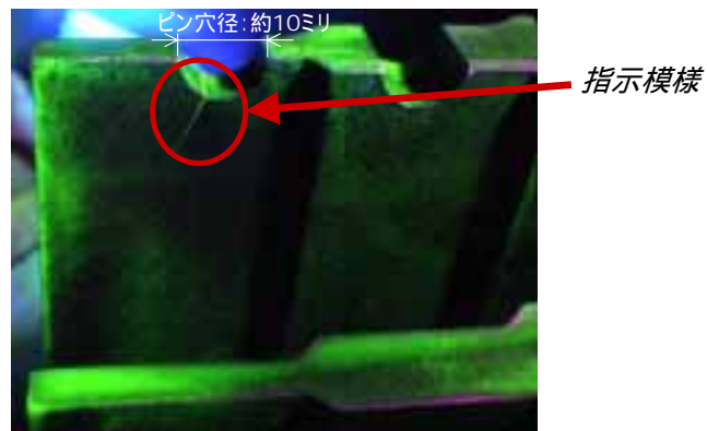
磁粉探傷検査による指示模様の例(1) (低圧タービン(C)第14段(タービン側)動翼(128枚目)フォーク部)(お知らせ済み)
