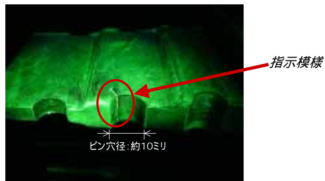
磁粉探傷検査による指示模様の例(2) (低圧タービン(B)第14段(タービン側)動翼(20枚目)フォーク部)
