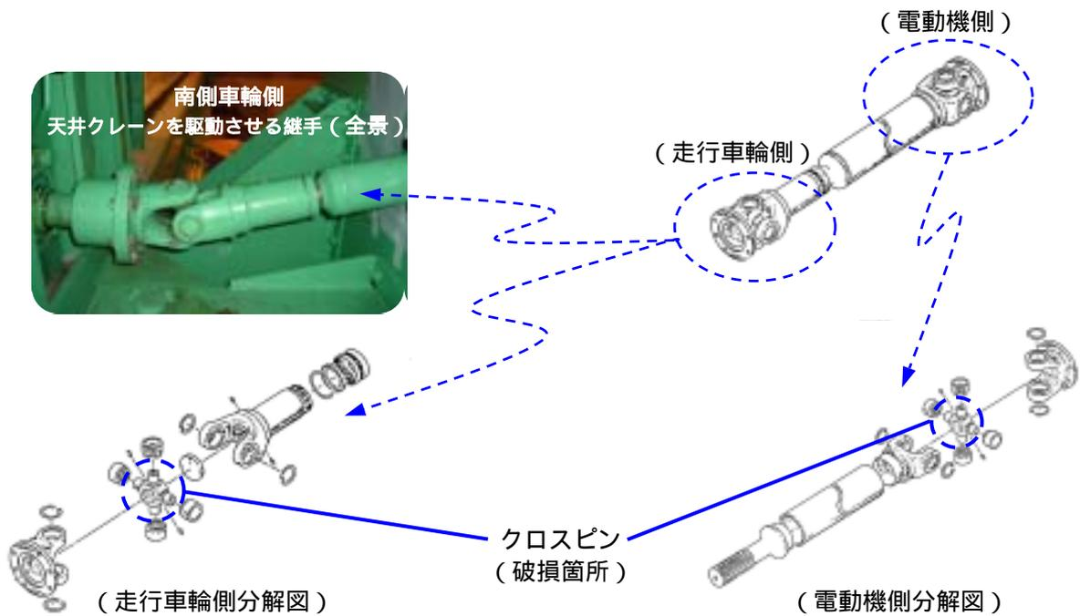
【天井クレーンを駆動させる継手の分解図】
