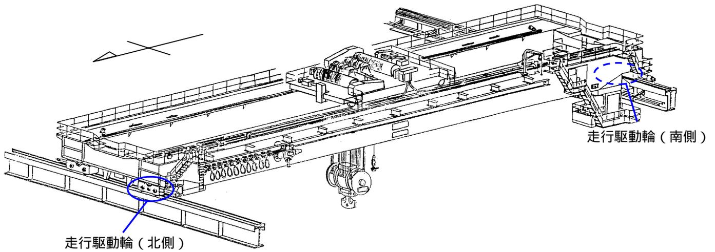
【原子炉建屋天井クレーン外観図】
