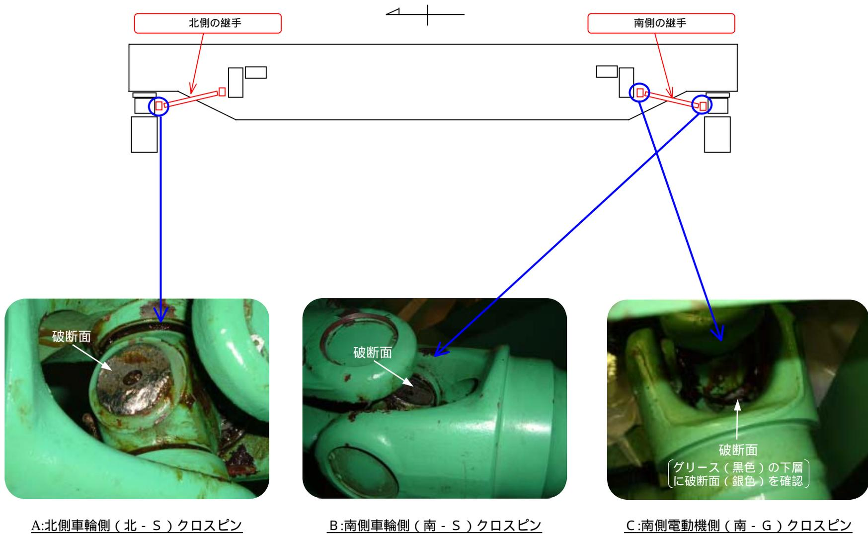
天井クレーンを駆動させる継手のクロスピン破損状況
