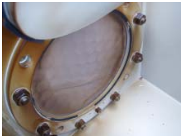
写真9, 10 放圧装置(安全ピンは破断し動作。放圧板にしわがあるが破れていない)
