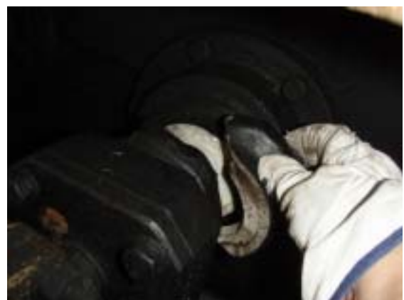
写真3 二次ブッシング碍管のひび割れ(容易に剥がれる) (上段V相)
