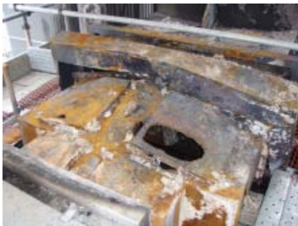
写真5 二次側接続母線部ダクト上面溶損穴
