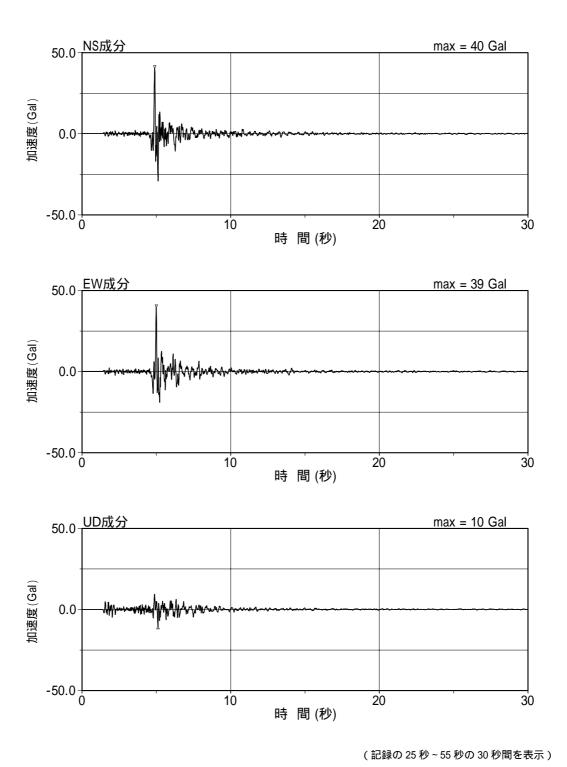
5 号機地盤系 (T.M.S.L.-300m) の加速度時刻歴波形 [2007年7月25日06時52分新潟県中越地方,G55観測点]
