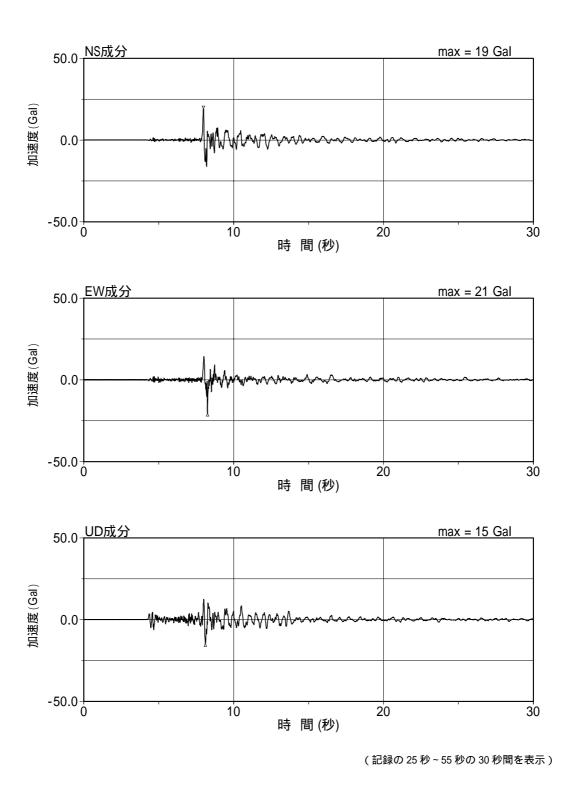
4号機原子炉建屋地下5階(基礎版上)の加速度時刻歴波形 [2007年7月25日06時52分新潟県中越地方,4-R2観測点]
