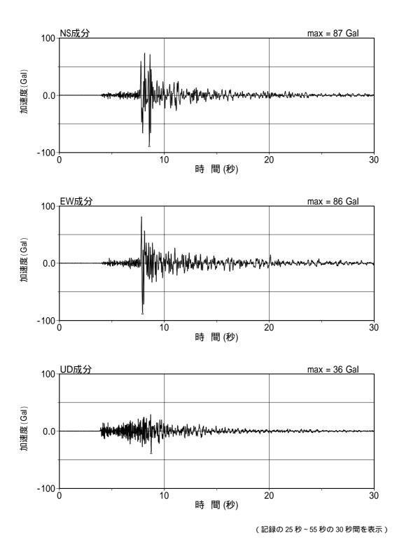
1号機地震観測小屋の加速度時刻歴波形 [2007年7月25日06時52分新潟県中越地方,1-G1観測点]
