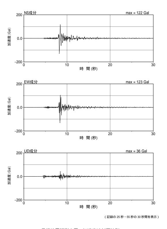
5 号機地震観測小屋の加速度時刻歴波形 [2007年7月25日06時52分新潟県中越地方,5-G1観測点]
