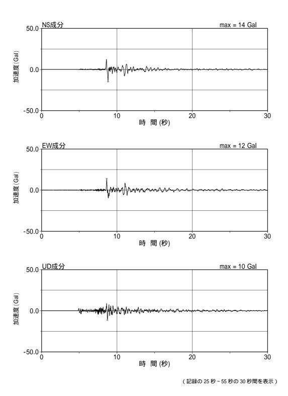
1号機原子炉建屋地下5階(基礎版上)の加速度時刻歴波形 [2007年7月25日06時52分新潟県中越地方,1-R2観測点]
