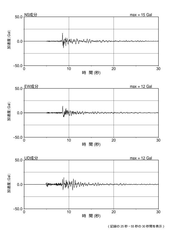
3号機原子炉建屋地下5階(基礎版上)の加速度時刻歴波形 [2007年7月25日06時52分新潟県中越地方,3-R2観測点]
