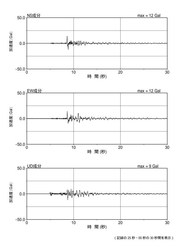
2号機原子炉建屋地下5階(基礎版上)の加速度時刻歴波形 [2007年7月25日06時52分新潟県中越地方,2-R2観測点]
