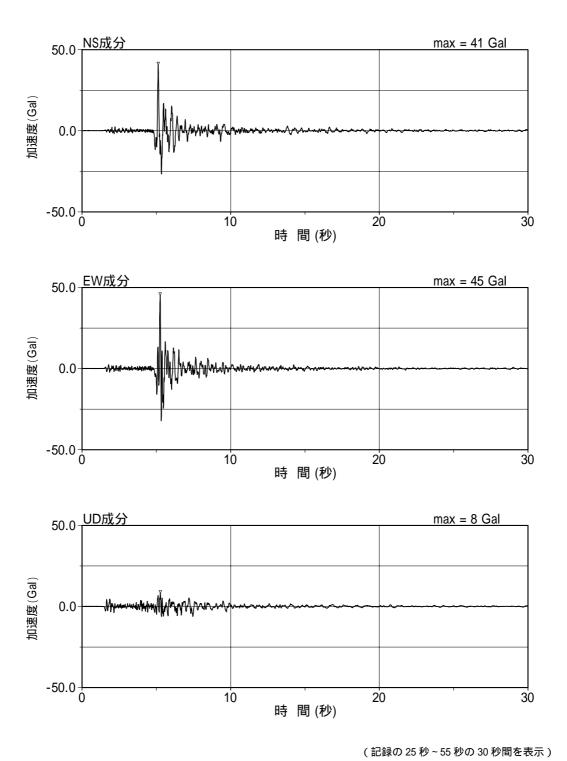
5 号機地盤系 (T.M.S.L.-100m) の加速度時刻歴波形 [2007 年 7 月 25 日 06 時 52 分新潟県中越地方, G53 観測点]
