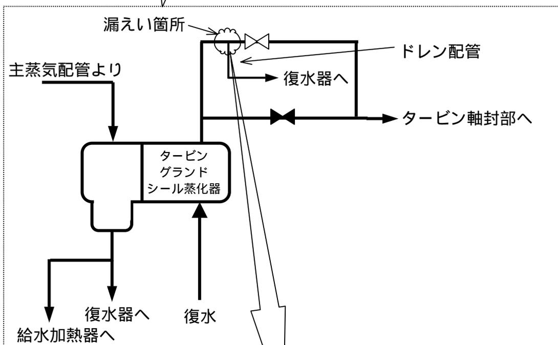
タービングランドシール蒸化系 系統概略図
