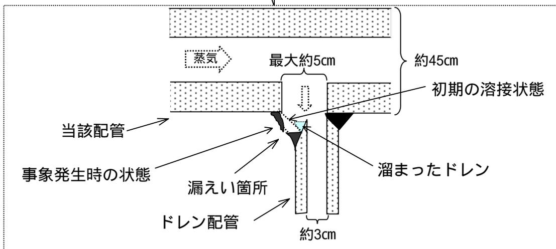
漏えい箇所 配管溶接部
