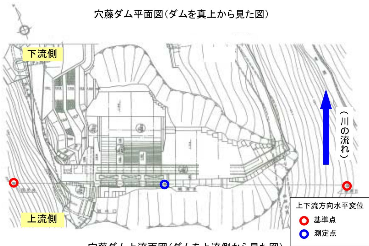
図 - 5 - 1 計測 測定点位置図(上下流方向水平変位)
