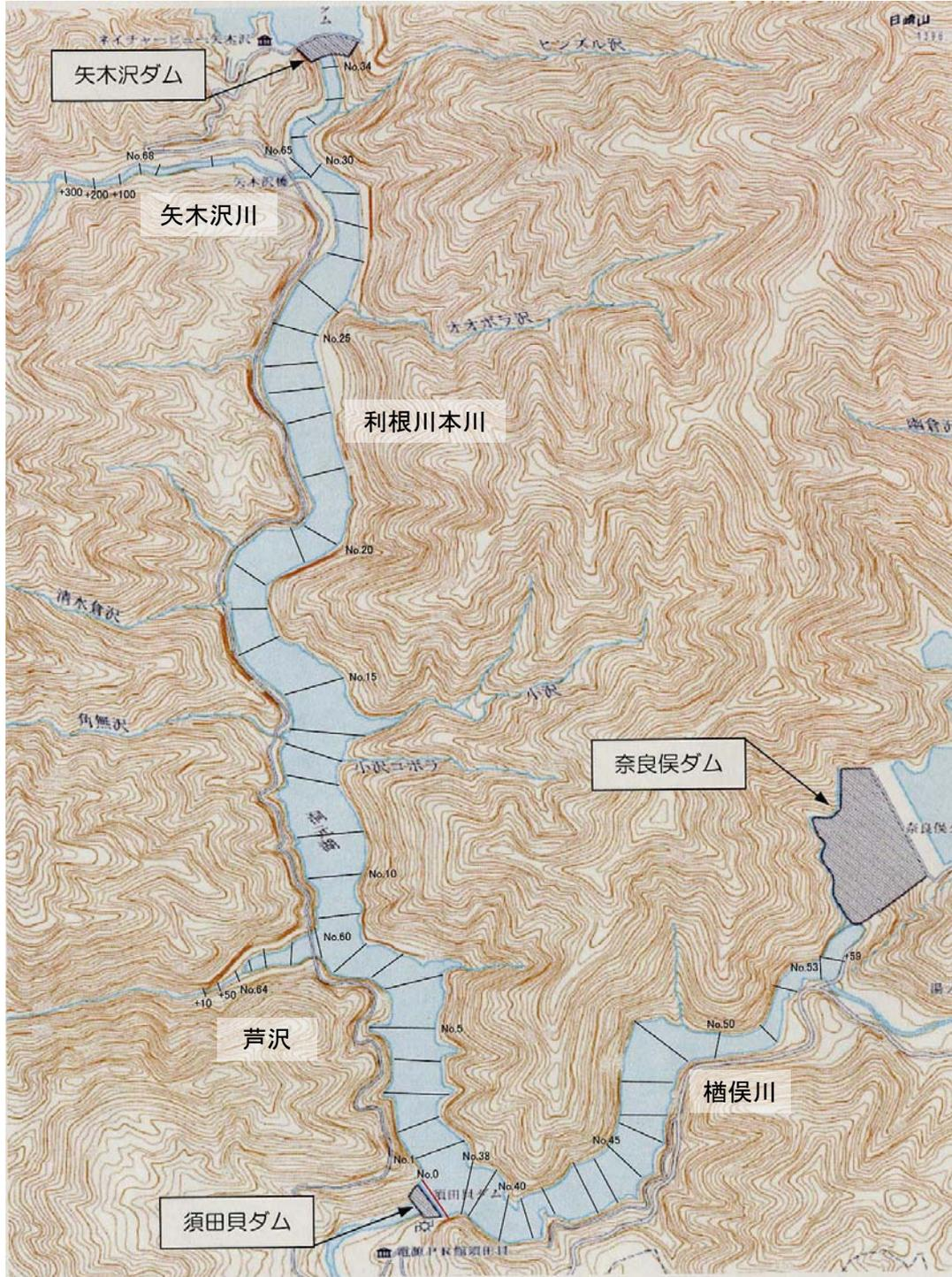
図-2-14 【須田貝ダム】深浅測量測線位置図
