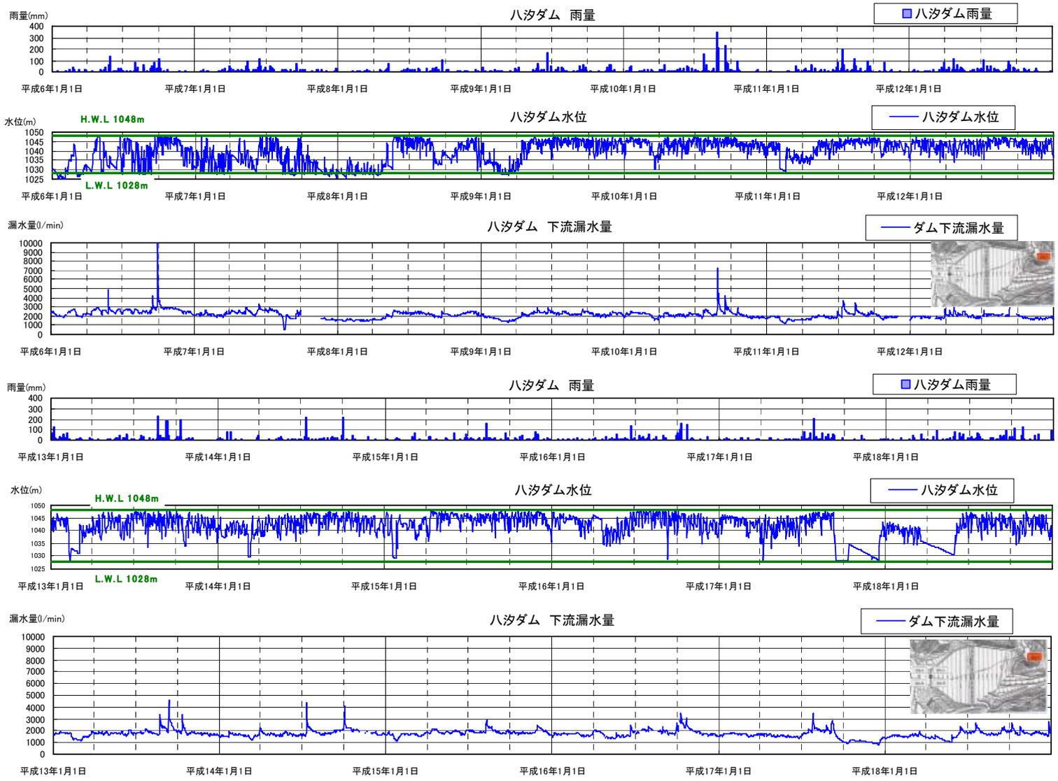
図-3-11 八汐ダム下流漏水量
