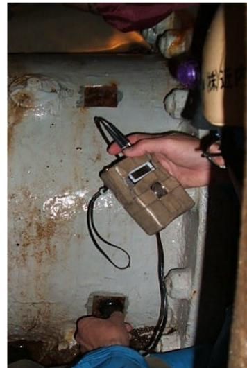
放流管の鉄管厚測定状況
