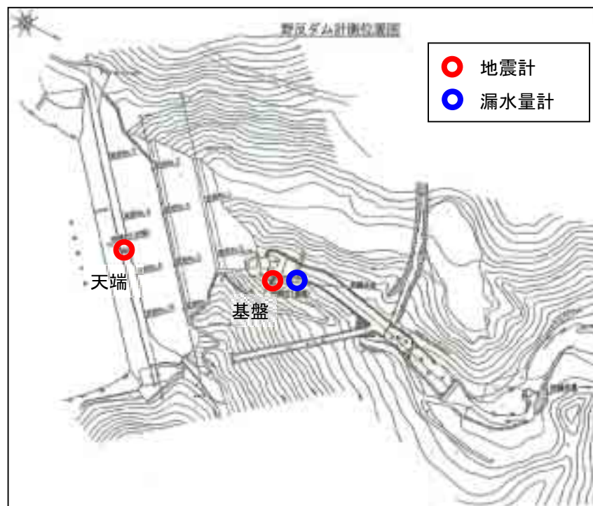
図-2 地震・漏水計測位置図
