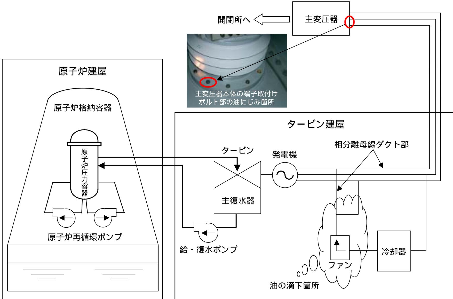
**4号機 油の滴下および油にじみ箇所図**
