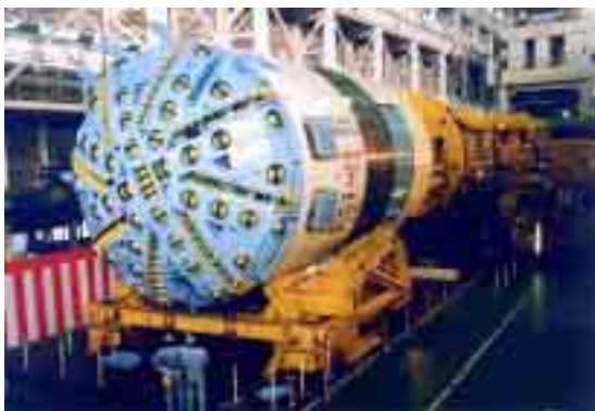
T B M (トンネルボーリングマシン) (掘削径：6.6m 機械全長：約 50m 総重量：約 600t)
