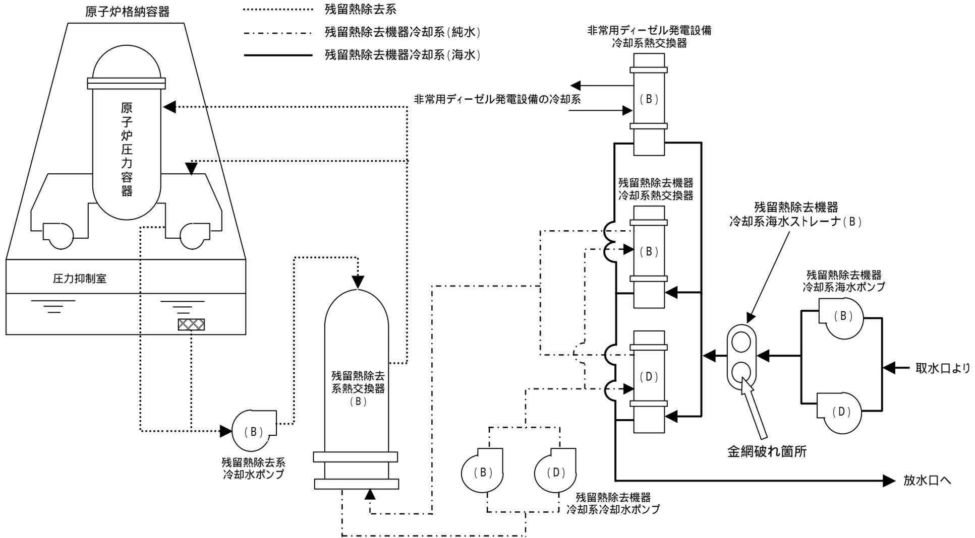
残留熱除去機器冷却系 概略図
