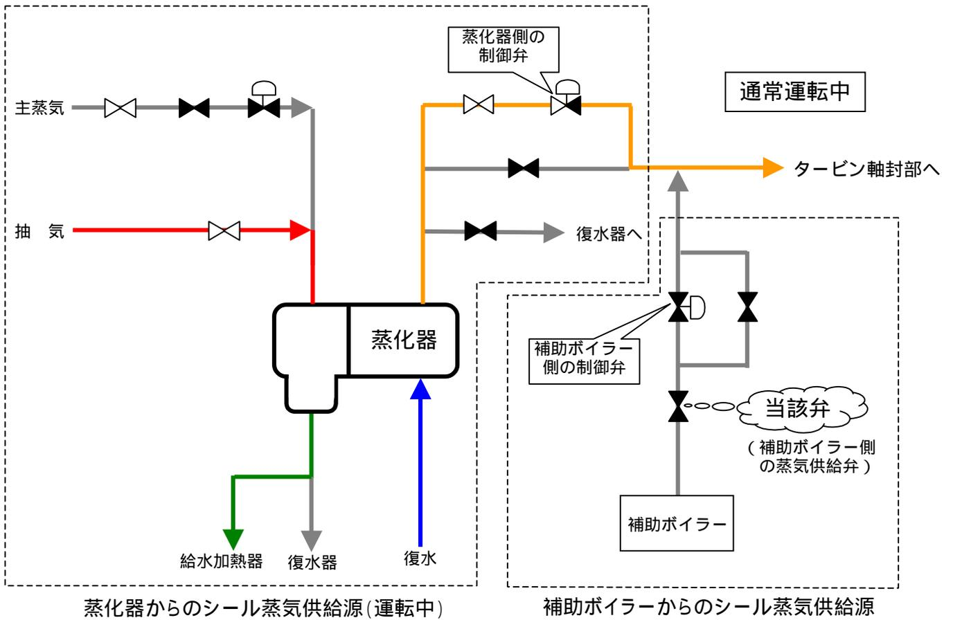
**タービングランドシール蒸気系 系統概略図**
