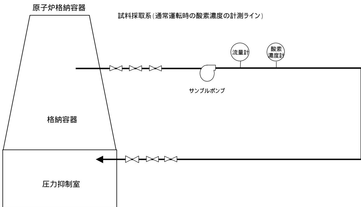
原子炉格納容器内水素・酸素濃度計測系概略系統図
