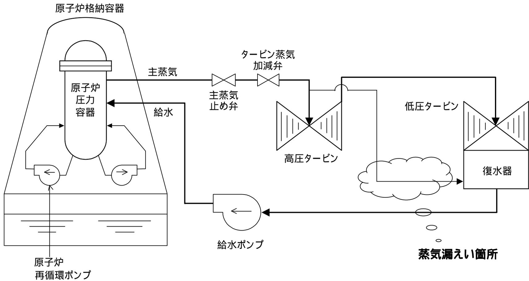
柏崎刈羽原子力発電所1号機 蒸気漏えい箇所 系統概略図
